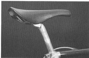
10 Ein fertig getunter Geierschnabel, der trotz Stahlgestell nur 240 Gramm wiegt und mit Alugestell auf 150 Gramm käme
